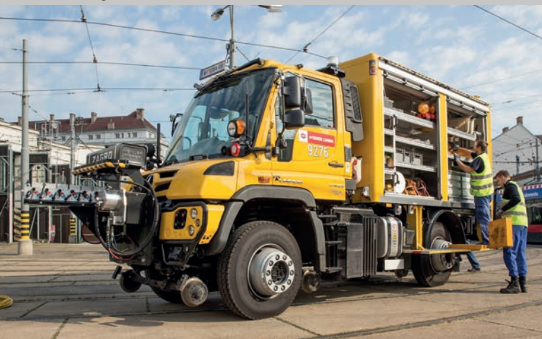
Unimog U 423 Hilfszug mit Drehschemel-Schienenführung Unimog U 423 rereiling vehicle with guidance bogie system
