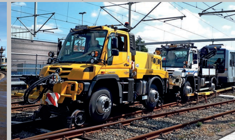
Unimog U 423 im Tandembetrieb zur Traktionserhöhung Unimog U 423 in tandem operation for higher tractive capacity
