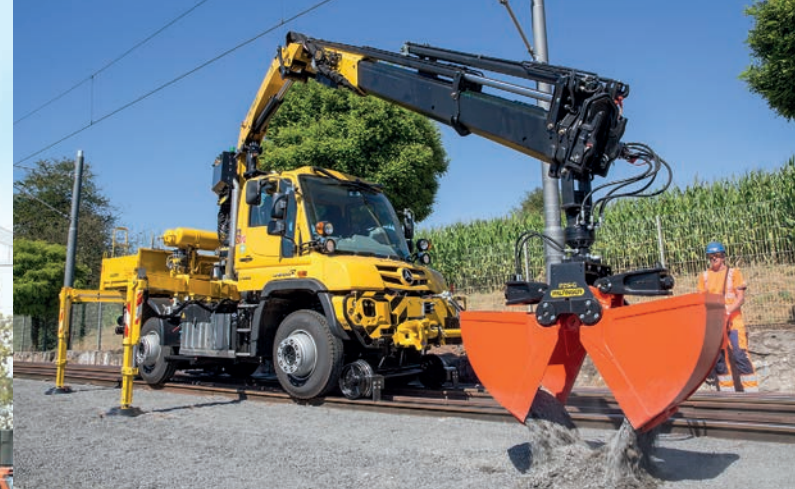
Unimog U 423 Arbeitsfahrzeug mit Zweischalengreifer Unimog U 423 working vehicle with clamshell buckets
