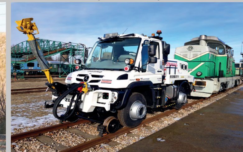
Unimog U 423 Rangierfahrzeug mit Waggonbremsanlage Unimog U 423 shunting vehicle with wagon brake system
