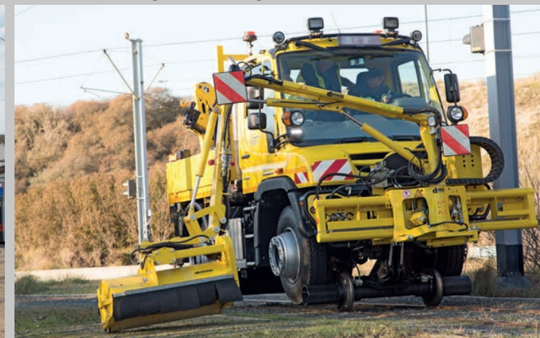
Unimog U 430 Arbeitsfahrzeug mit Reibrad-Schienenführung Unimog U 430 working vehicle with friction drive system
