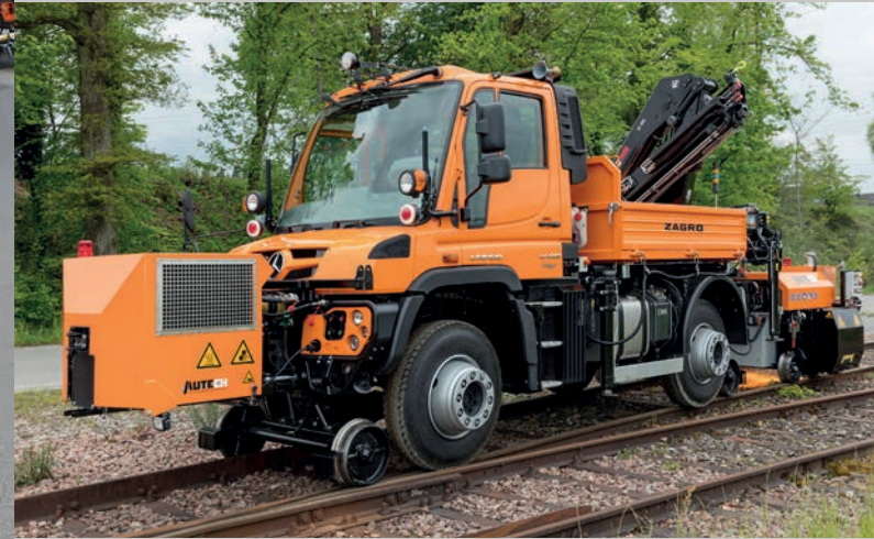
Unimog U 423 Arbeitsfahrzeug mit Schienenschleifeinheit Unimog U 423 working vehicle with rail grinding unit
